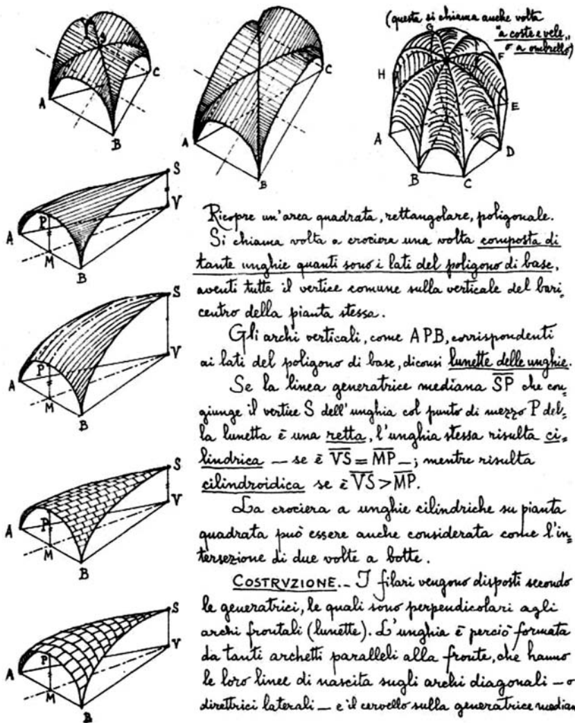
Tav. VI - Volta a crociera (da G. Zander, Appunti del corso di Storia dell'Architettura I , a.a. 1984-85, facoltà di Architettura, Università degli Studi di Roma "La Sapienza")
